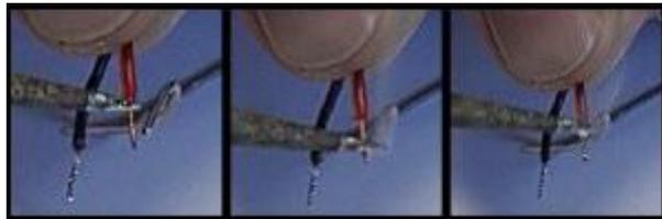
4. Укоротить выводы светодиода и резистора и также залудить их. Хотя выводы и лудились при изготовлении радиоэлементов, но в процессе хранения на них мог образоваться тонкий слой окислов. После лужения поверхность вновь будет чистой. Если используются очень старые радиодетали, выпаянные из каких-либо плат, на них, как правило, сильно окислены. Выводы таких деталей перед лужением необходимо очистить от окислов, например, поскрести их ножом.
